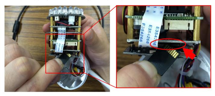
6. micro SDカードを差し込んだら、逆の手順で防犯カメラを組み直せば、これで取付作業が完了です。
