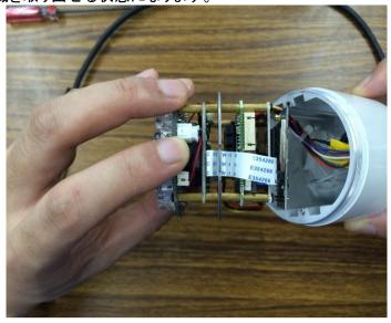
5. 基盤の後ろの鉄板の裏にmicro SDカードの挿入口があります。
