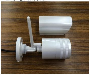
2. 左手で本体の固定した状態で先端のカメラレンズカバーを内側に回して、レンズカバーを外します。
