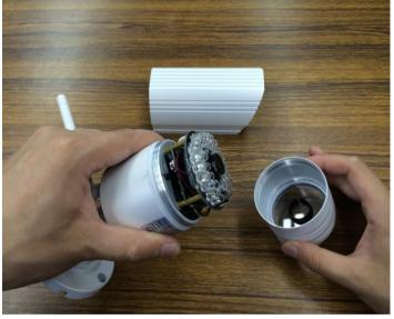
3. レンズカバー外された状態で見えてきた左右二つのねじをドライバーで外します。
