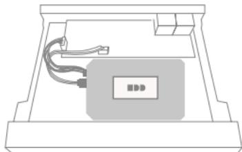
⑤ HDD を付属のネジで固定します。
