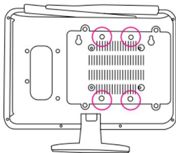
③ HDD とカバーをネジで4カ所固定してください。
