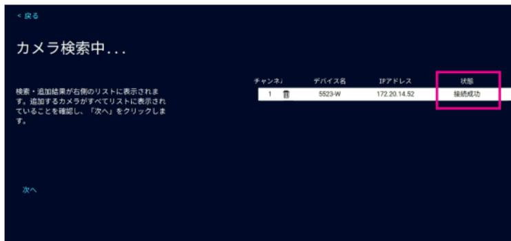
5. 「接続成功」になったら、カメラから LAN ケーブルを抜きます。
